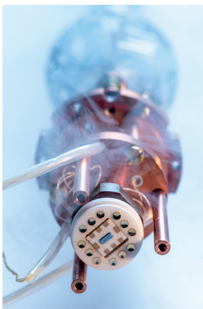
↑ Etalon à effet Hall quantique au BIPM. Source : Stroppa-BIPM
